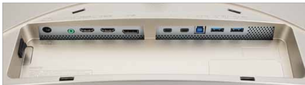
Все интерфейсы спрятаны за полукруглой вставкой на задней панели монитора
